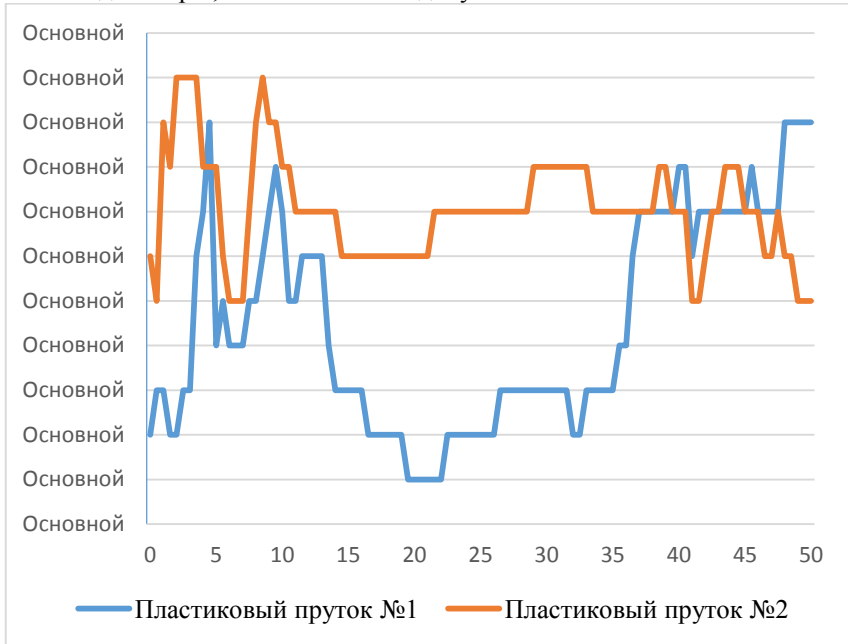
Рисунок 2 – Результаты измерения диаметров прутков Ось абсцисс – длина прутка (см), ось ординат – диаметр прутка (мм).
