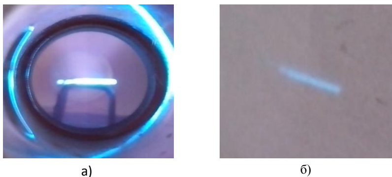
Рис. 1 — Свечение \text{Al}_{0.74}\text{Ga}_{0.26}\text{N} структур: а — свечение структуры под воздействием электронного пучка; б — проекция свечения структуры на листе белой бумаги
