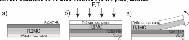
Рис. 2 – Процесс формирования двойного слоя из позитивного (AZ5214E) и негативного (SU-8) резистов на кремниевой подложке
