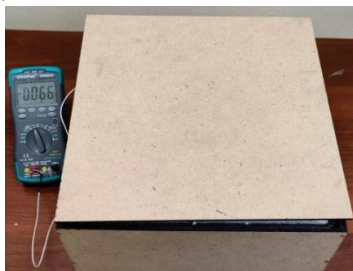
Рис. 3 – Нагрев экспериментального образца. Охлаждающая камера накрывается теплоизоляционной крышкой, обратная сторона изоляционной крышки покрыта слоем фольгированного пенополистирола для дополнительной теплоизоляции.
