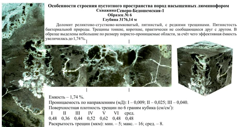
**Рис. 2.** Рис. 2 Доломит реликтово-сгустково-комковатый с редкими тонкими хаотичными трещинами. Ёмкость составляет 1,74%, проницаемость до 0,04 мД. Обр. № 6, скв. Северо-Бедошемская-1, глуб. 3176,14 м.
