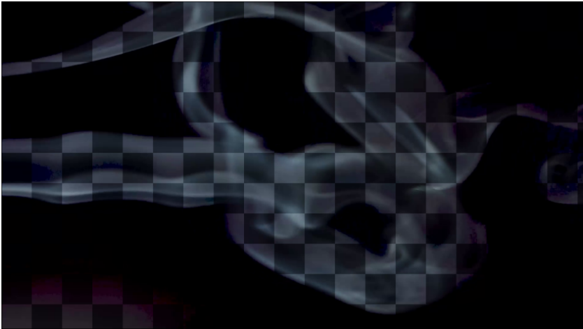
Рис. 1 Кадр до и после преобразования. Визуализация: шахматная доска. Значение VMAF NEG было повышено на 23.43%(с 58.12 до 81.71)
