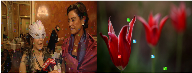
Рис. 1. Слева: артефакты потери данных в поврежденном кадре mpreg2 видео. Справа: этот же тип артефактов, но уже в mpreg4 видео.
