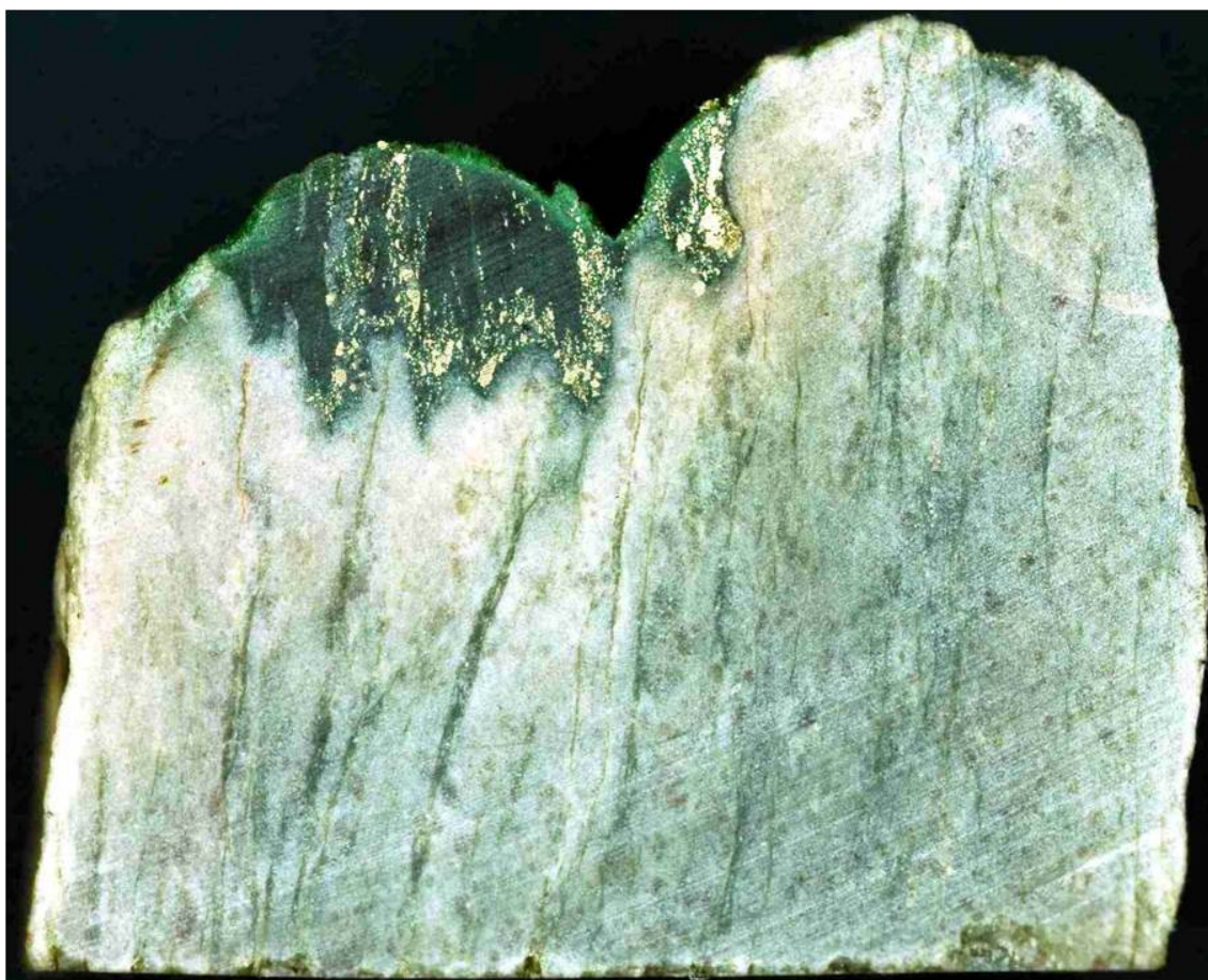
Рис. 1. Приуроченность золота и особенно более крупных и изометричных золотинок к поверхности коренного палеоплотика.
