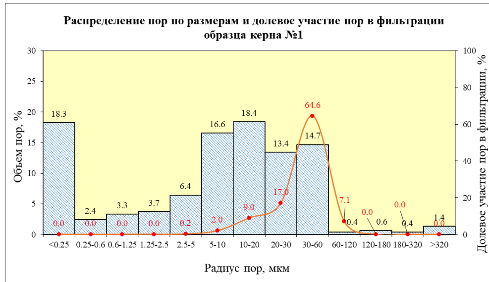
Рис. 1. Распределение пор по размерам и долевое участие пор в фильтрации образца реального керна
