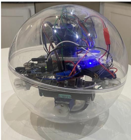
Рис. : Рассматриваемая модель сферического робота
