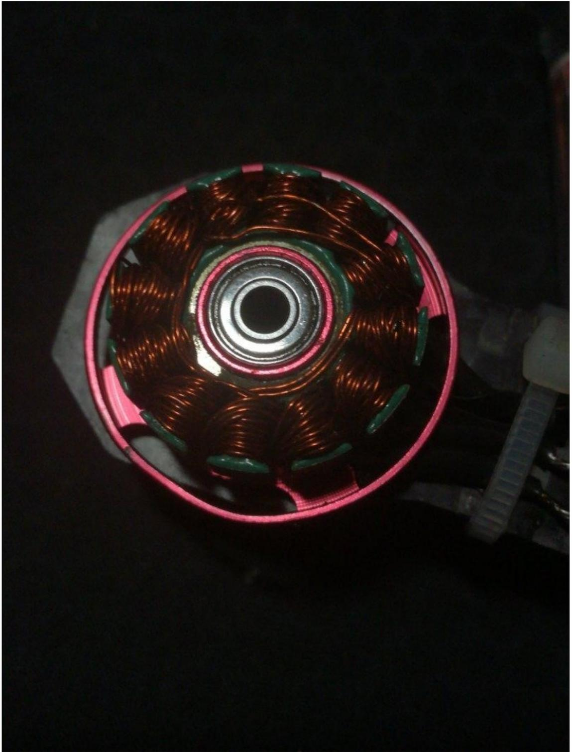
Рис. Процесс восстановления двигателя с оплавившейся обмоткой путём наматывания новой вручную
