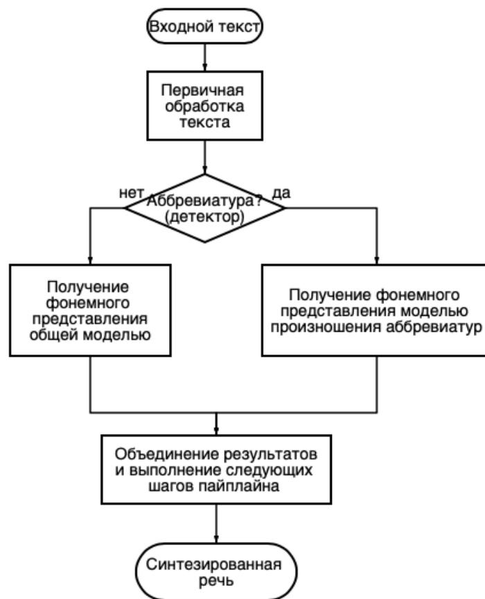
Рис. : 1. Упрощенная схема модифицированного пайплайна.
