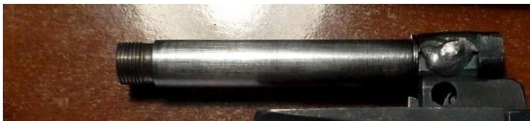
Рис. : Фото 4. Наплывы металла в месте соединения стойки со стволом.
