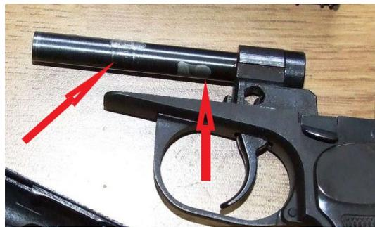
Рис. : Фото 2 и 3 – примеры восстановления структурной целостности ствола пистолета посредством применения холодной сварки
