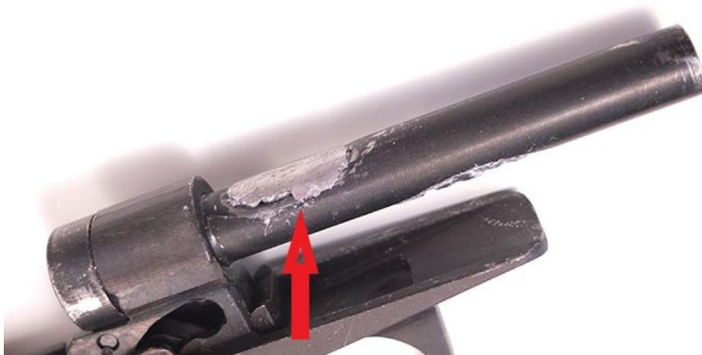
Рис. : Фото 2 и 3 – примеры восстановления структурной целостности ствола пистолета посредством применения холодной сварки
