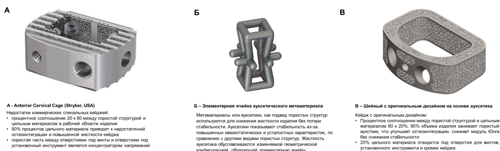
Рис. : Рисунок 1 – Коммерческий кейдж компании Stryker, USA (А), Элементарная ячейка ауксетического метаматериала (Б), шейный кейдж с оригинальным дизайном на основе ауксетической структуры (В)
