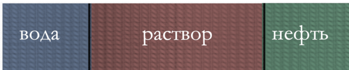
Рис. : Схема течения при заводнении полимерным раствором
