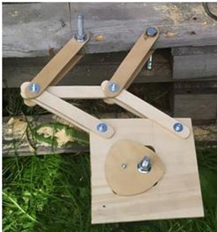
Рис. : 2. Единичный опытный грейферный механизм.
