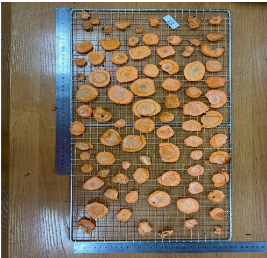
Рис. : Лоток, ломтики находившиеся около тэнов высушились быстрее
