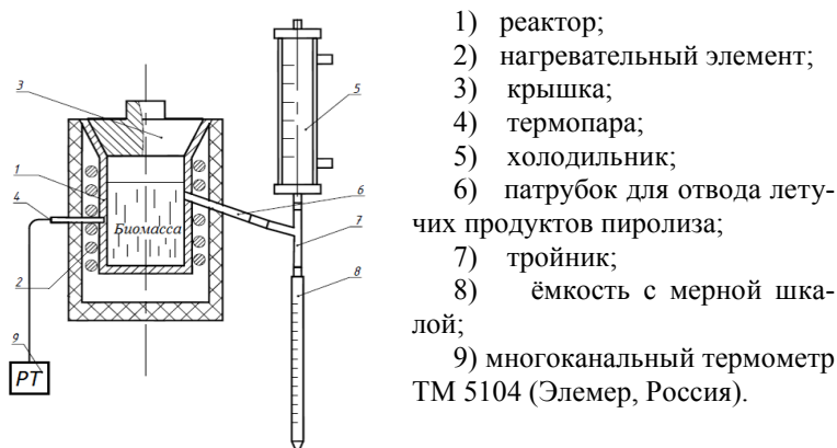
Рис. 1 – Установка для определения динамики выхода пиролизного конденсата
