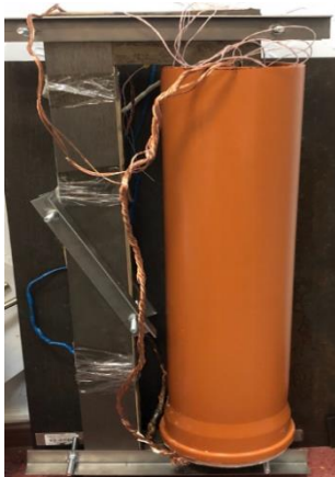
Рис. 1 – Физическая модель экспериментального ВТСП трансформатора
