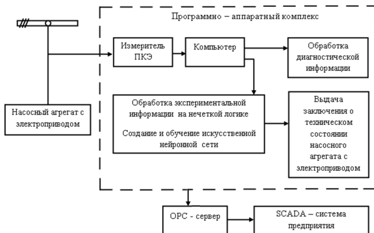
Рис. 2 – Структурная схема программно-аппаратного комплекса интеллектуальной системы диагностики насосных агрегатов
