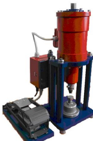
Рис. 2 – Электромагнитный пресс на базе однокатушечного линейного ЭМД
