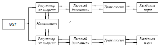
Рис.4 - Структурная схема КЭУ с электрохимическим генератором
