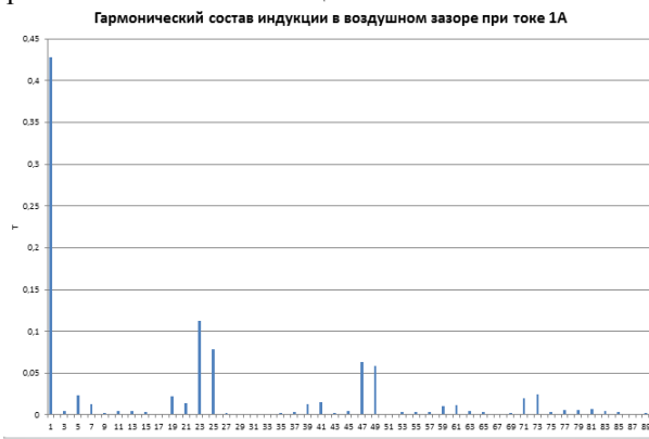
Рис. 4. Гармонический состав индукции в воздушном зазоре
