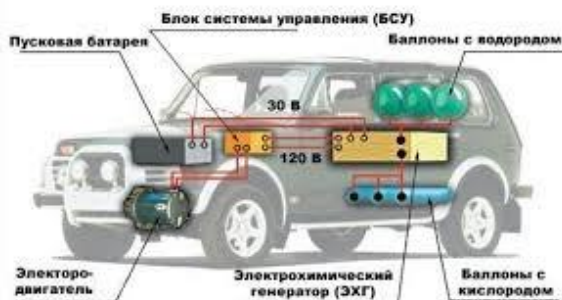
Рис. 5 - Схема КЭУ с электрохимическим генератором
