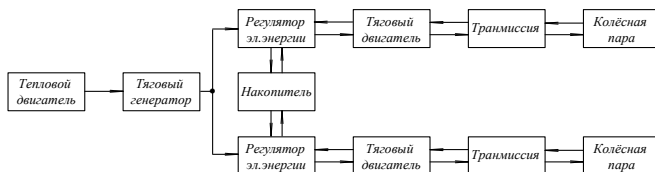
Рис. 2 - Структурная схема КЭУ с тепловым двигателем
