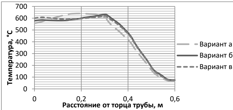
Рисунок 2 – Распределение температурного поля для различных конструкций индуктора
