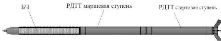
Рис. 4 - Конструктивно-компоновочная схема ракеты для КББ.
