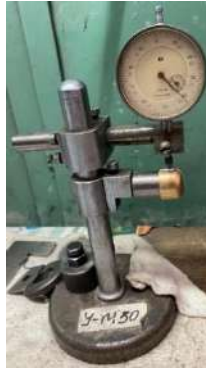
Рис. 3 – Установка для замера разностенности Результаты замера приведены в таблице 1.
