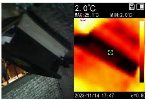
Рис. 6 – Термограмма внутреннего радиатора при отключенном обдуве
