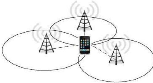
Рис. 1 – Оценка положения мобильного устройства с помощью трилатерации
