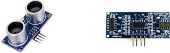
Рис. 1 – Ультразвуковой датчик HC-SR04
