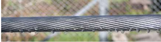
Рис. 2 – провод без покрытия после 120 мин. дождя
