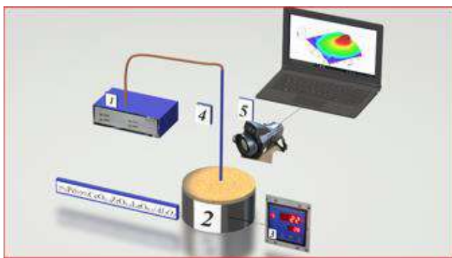
Рис.1 – 1 – генератор поверочных газовых смесей УФПГС -2; 2 – нагреваемая пластина с каталитической поверхностью; 3 – управление электрическим нагревателем; 4 – трубка; 5 - тепловизор
