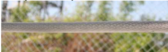
Рис. 3 – Провод с МДО-покрытием после 120 мин. дождя
