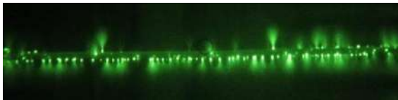
Рис. 4 –Эопограмма КР провода без покрытия под дождем: 180 кВ
