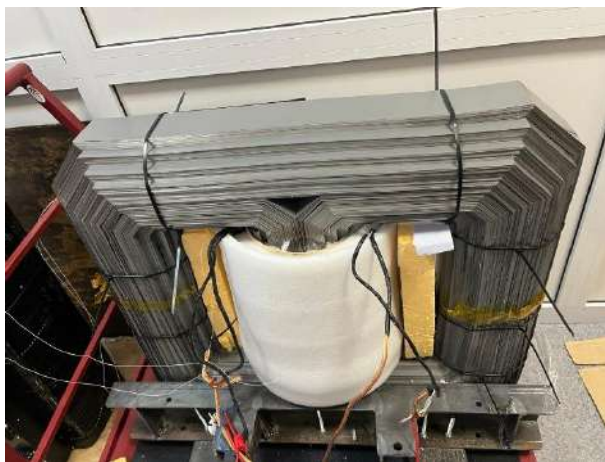
Рис.1 – Разработанный прототип ВТСП трансформатора
