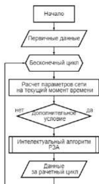
Рис.1 – Блок схема имитационного алгоритма реального времени
