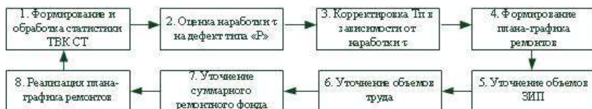
Рис. 3 – Структура алгоритма технологии адаптивного управления ремонтами СТ КТП 6(10)/0,4 кВ по прогнозируемой наработке
