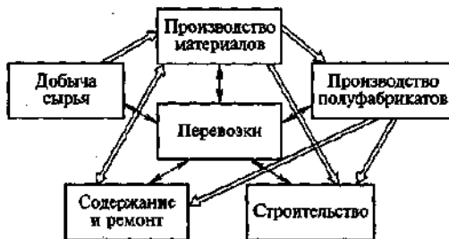
Рис. 1 – Схема системы производств в дорожном строительстве и транспортных услугах
