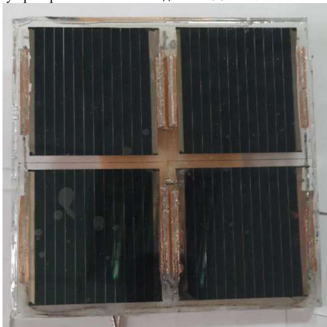
Рис.2 – Экспериментальная перовскитная солнечная панель
