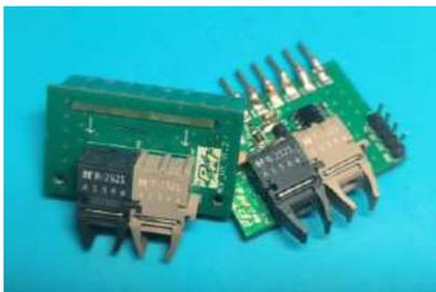
Рис. 2 – Модули оптического трансивера. Слева с выходами параллельно высоковольтному проводу, справа – перпендикулярно проводу.
