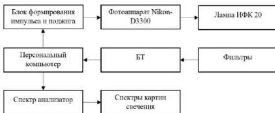
Рис. 2 – Блок схема установки для стимуляции и регистрации спектров вынужденного свечения
