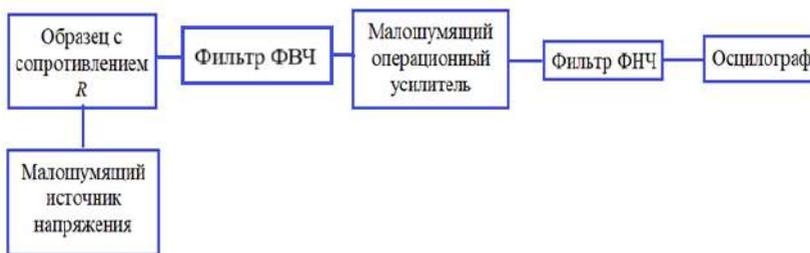
Рис.1 – Схема измерения низкочастотных шумовых флуктуации
