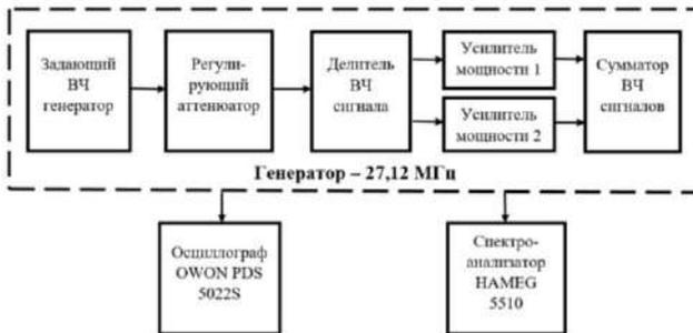
Рис. 1 – Схема ВЧ генератора на частоту 27,12 МГц.
