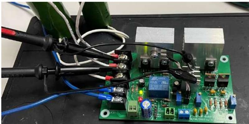
Рис. 4 – Фотография опытного образца инвертора во время испытаний
