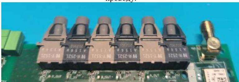
Рис. 3 – Фрагмент изображения печатной платы вторичного преобразователя КЦТТН с оптическими передатчиками и приёмниками для трех первичных преобразователей.
