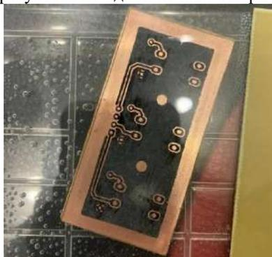
Рис. 1 – Результат применения метода лазерного утюга
