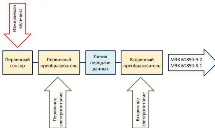
Рис. 1 – Структурная схема КЦТТН.
