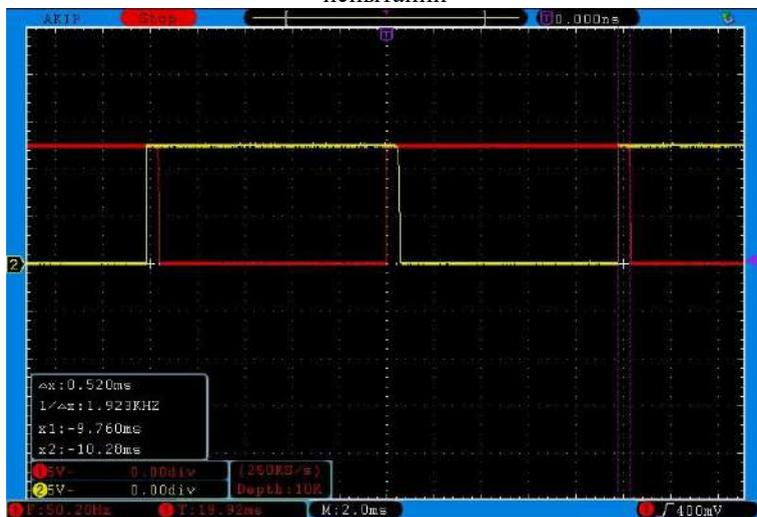
Рис. 5 – Осциллограммы выходного напряжения опытного образца инвертора во время испытаний на резистивную нагрузку
