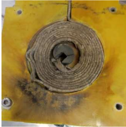
Рис. 2 – Повреждения спирального индуктора вследствие межвиткового замыкания
