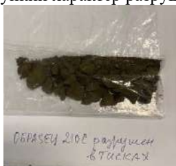
Рис. 3 – Вид фрагмента после разрушения сжатием
