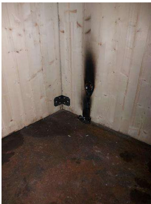
Рисунок 3 Модель стенда для испытаний и модельный очаг пожара с установленным оросителем по сценарию №2 (после испытаний)
