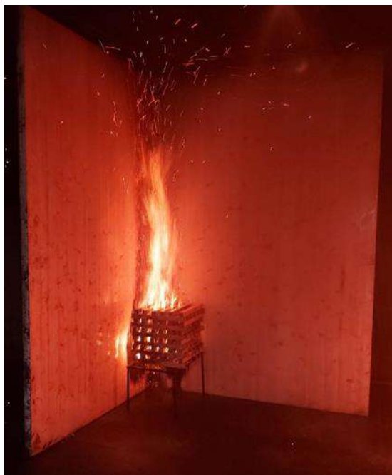
Рисунок 2 Модель стенда для испытаний и модельный очаг пожара с установленным оросителем по сценарию №1 (во время испытаний)
