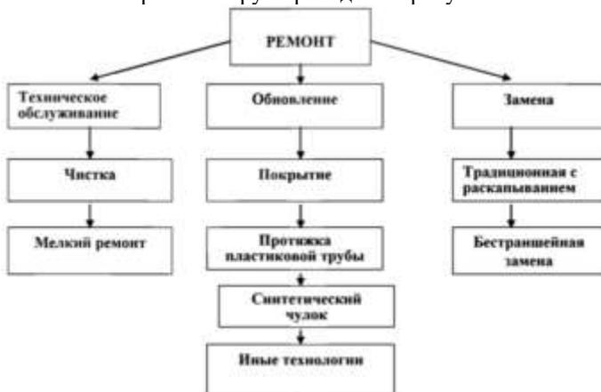
Рис. 1 - Перечень способов ремонта
