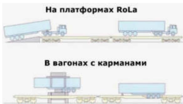
Рис. 2 –Схемы размещения контрейлера на платформе
