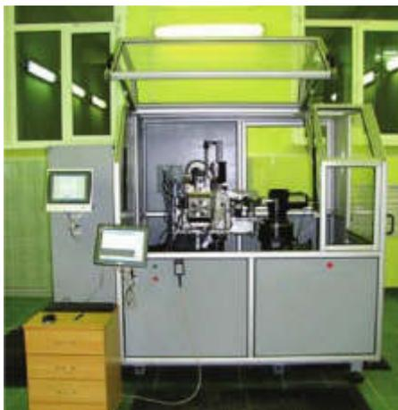
*Рис. 2 – Установка магнитреологического полирования*
