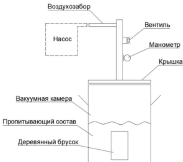
*Рис. 1 – Схема вакуумной камеры*
