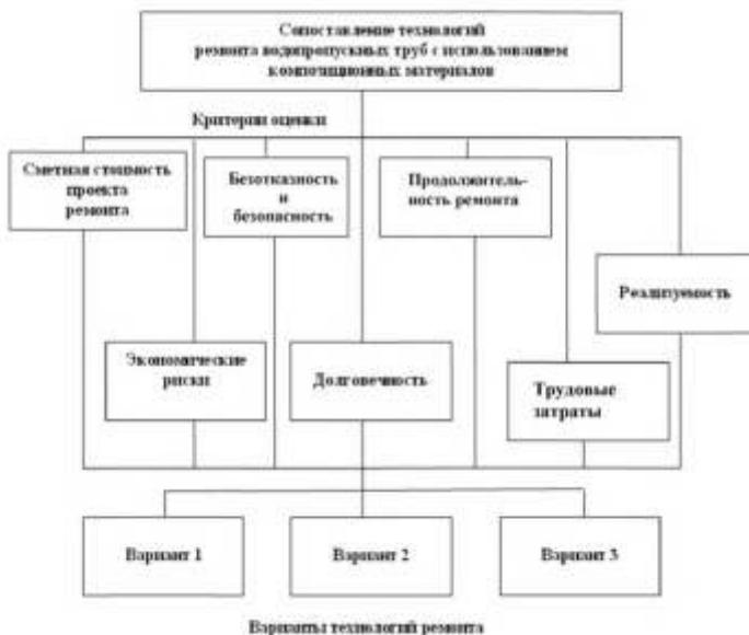
Рис. 2 - Алгоритм принятия решения при выборе технологии ремонта труб
