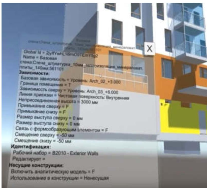
Рис. 2 – Просмотр IFC-свойств выбранного объекта
