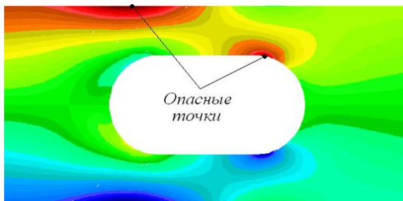
Рисунок 3 – Поля нормальных напряжений: а – радиус закругления 3мм, б – радиус закругления 5мм
