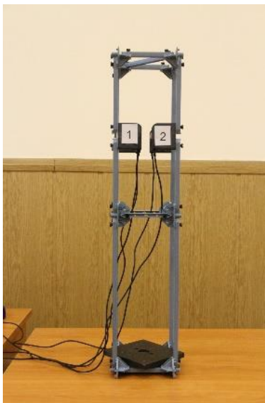
Рисунок 1 - Схема и экспериментальная модель башенного крана
