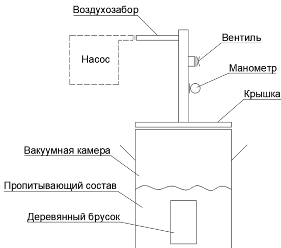
Рисунок 1 – Схема вакуумной камеры
