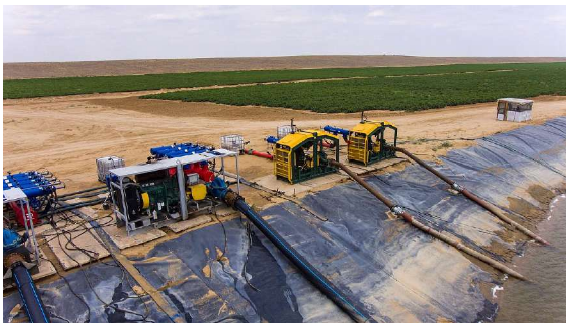
Рис.1 На первой фотографии изображена станция, которая служит для перекачки воды и подачи ее в автоматическую систему полива
