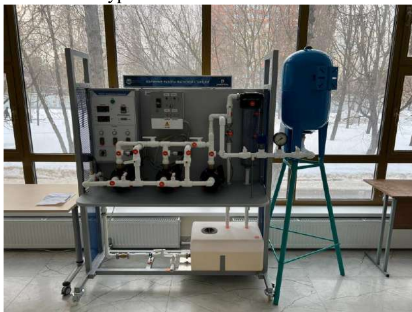
Рис. 2 Испытательный стенд системы водоснабжения с применением гидроаккумулятора
