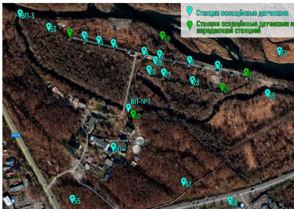
Рис. 1 Автоматизированная система контроля показателей подземных вод скважинного водозабора «Авачинский».
