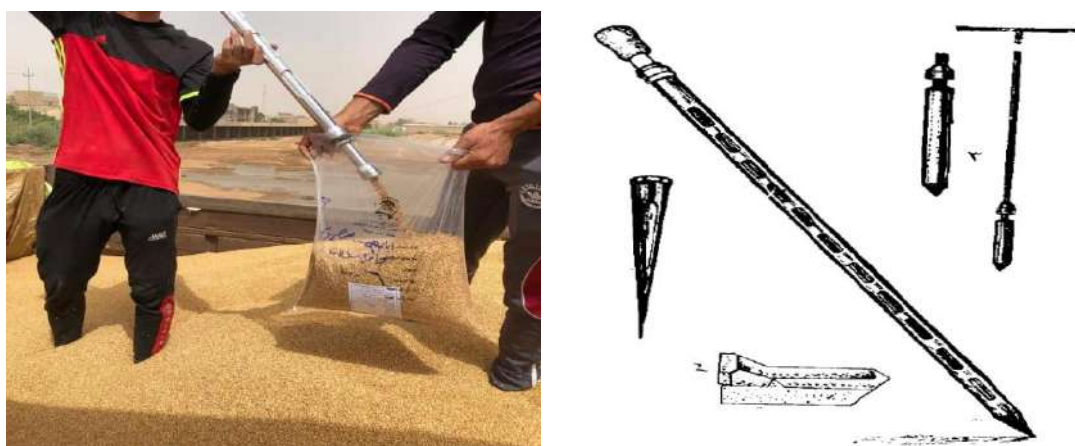
Рис. 1 Форма и детали устройства, с помощью которого отбирались пробы
