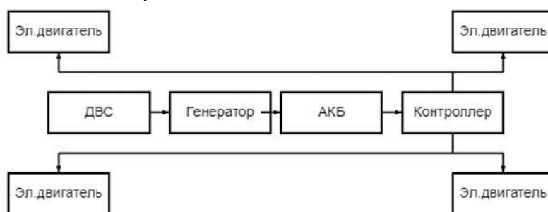
Рис. 1 Общая схема комбинированной гибридной силовой установки №1
