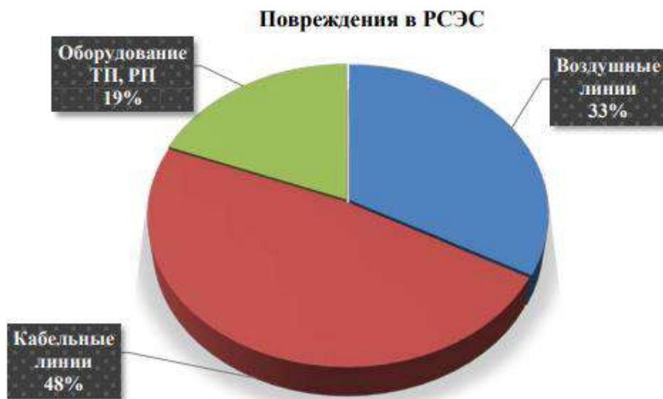
Рис. 1 Повреждения в распределительных сельских электрических сетях
