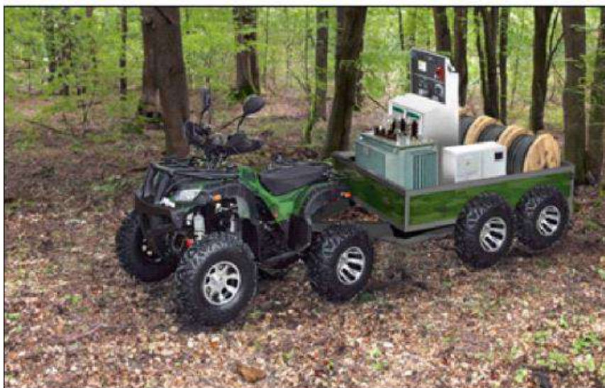
Рис. 2 Мобильная модульная трансформаторная подстанция
