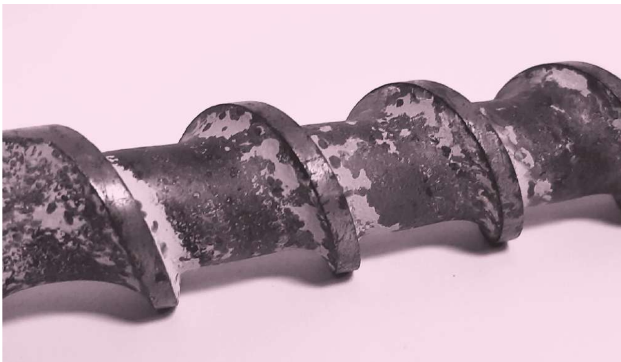
Рис. 2 Коррозионный износ шнека
