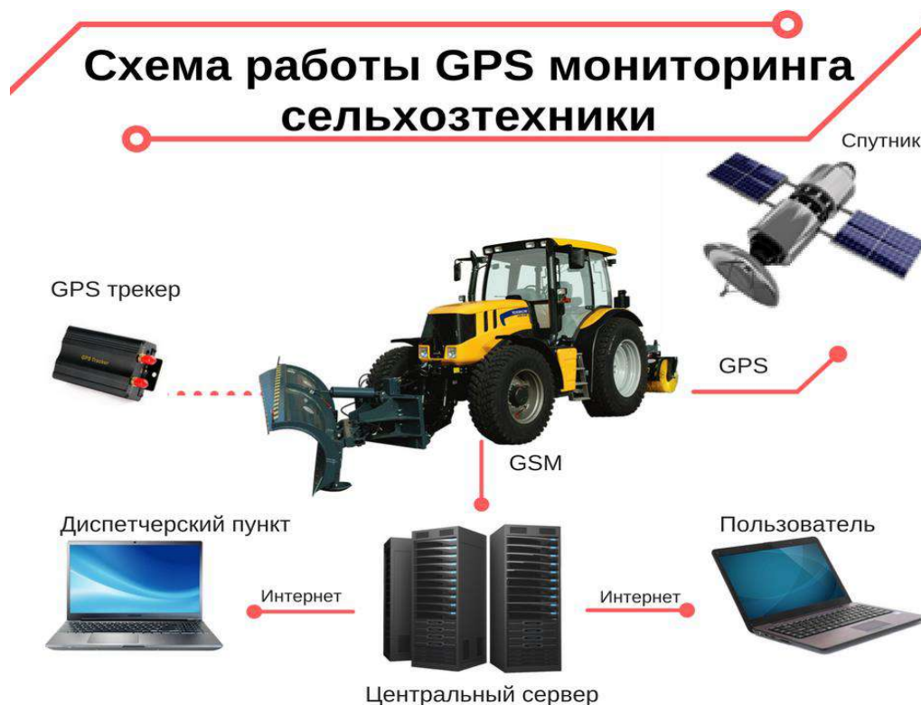
Рис. 1 Схема мониторинга сельскохозяйственной техники с помощью GPS-трекинговых систем
