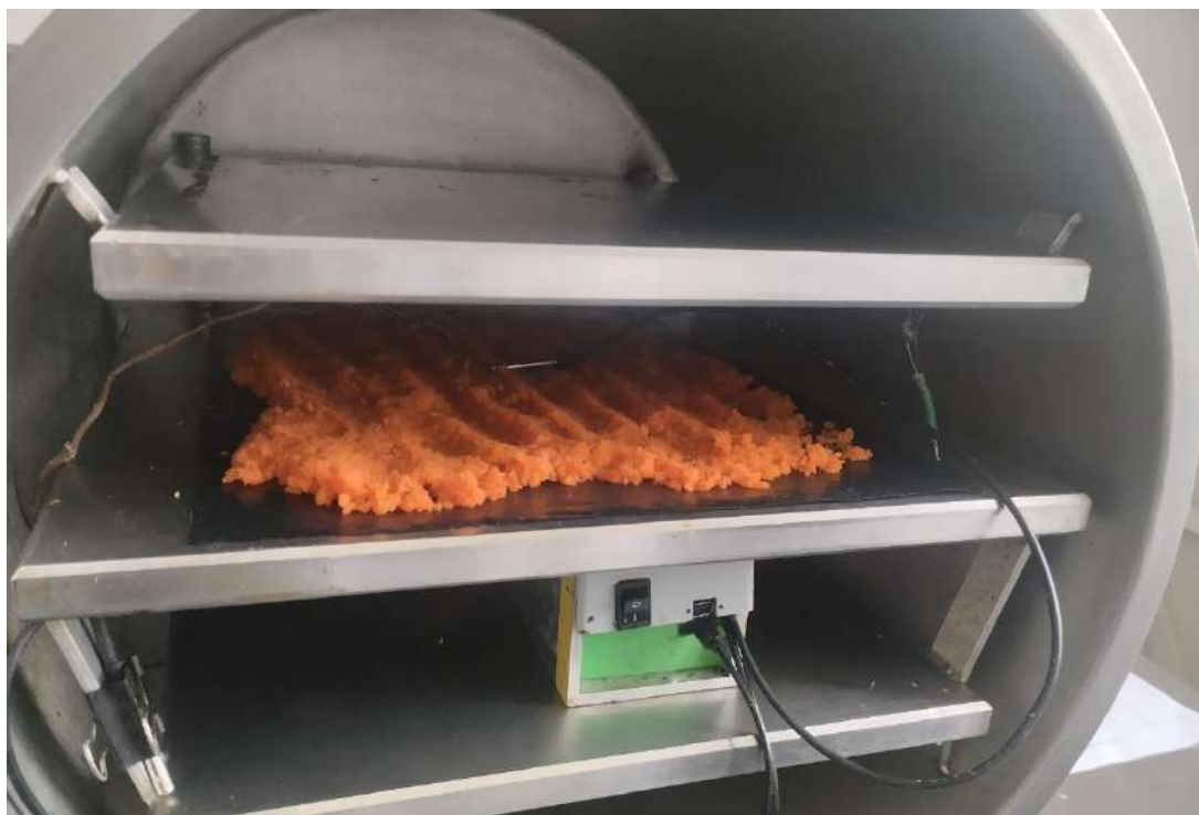
Рис. 1 Сушка мезги моркови в вакуумной камере
