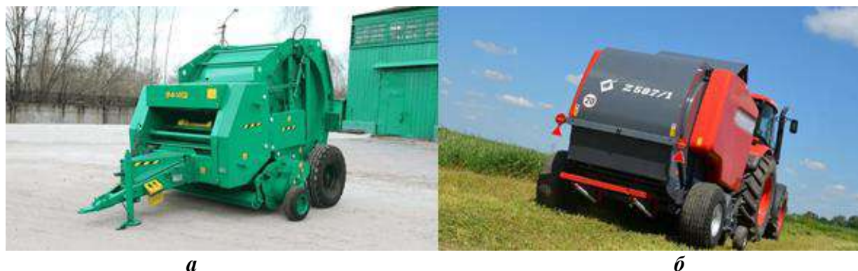
Рис. 2. Пресс-подборщики: а – Ленмаш ПРФ-145; б – Metal-Fach Z587/1.
