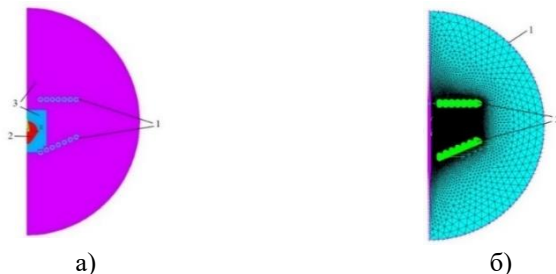
Рис. 2 – а) Геометрия электромагнитной задачи: 1 – индуктор; 2 – расплав; 3 – воздух; б) Сетка электромагнитной задачи с граничными условиями: 1 - A_z = 0 ; 2 – задано действующее значение тока 650 А с частотой 9650 Гц.
