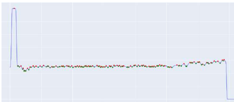
Рис. 4. - Профиль волны с пиками и впадинами для изображения реального эксперимента сварки двух металлов взрывом.
