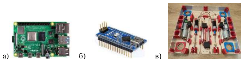
а) Raspberry Pi4 Model B; б) Arduino Nano; в) сборка корпуса
