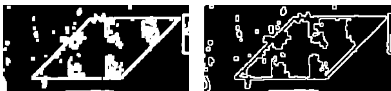
Рис.4-5 – Результат работы детектора границ Канни после нормализации – слева; границы, представленные цепным кодом Фримана – справа
