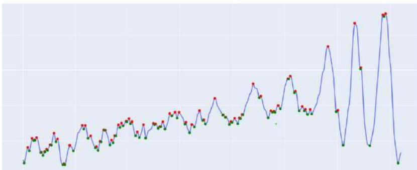
Рис. 3. - Профиль волны с пиками и впадинами для изображения моделирования сварки двух металлов взрывом.
