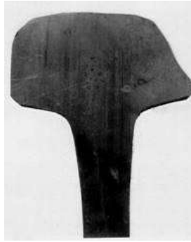
Рис. 1 – Профиль рельса, подверженного износу
