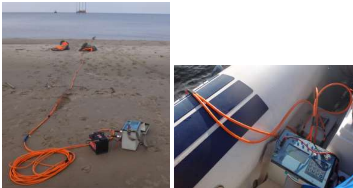
Рисунок 2. Донная коса при расположении станции на берегу и в лодке.
