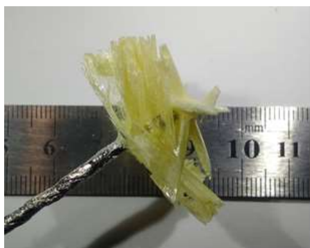
Рис. 4. Выращенные на теплоотводе кристаллы (Yb,Tm,Ho)_2Mo_3O_{12} .
