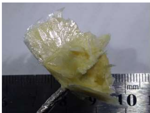
Рис.2. Pt теплопровод со слюдоподобными кристаллами KYb_{0.99}Tm_{0.005}Ho_{0.005}(MoO_4)_2 .
