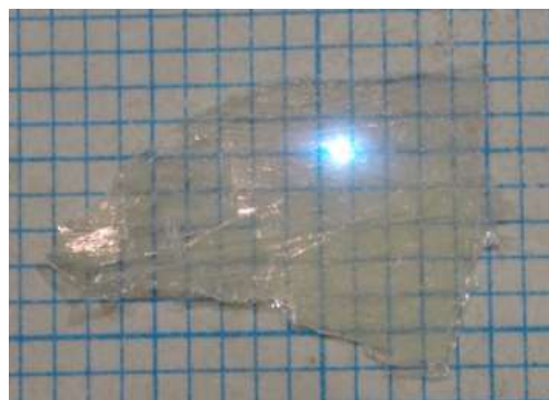
Рис.3 Люминесценция отдельного слюдоподобного кристалла при возбуждении источником с длиной волны 980 нм.
