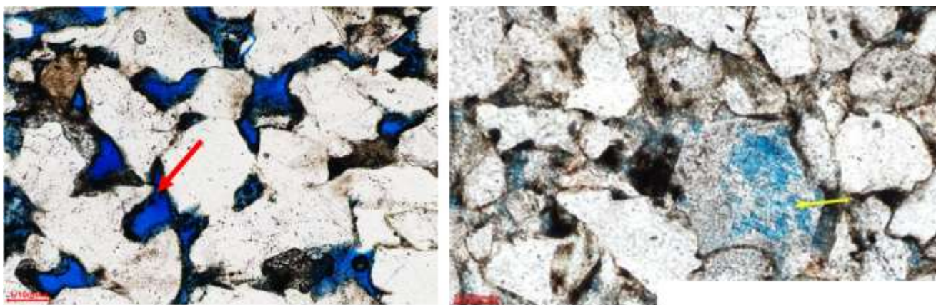
Рисунок 1. Интенсивное растворение кристаллов кварца и кислых полевых шпатов (Ковыктинское ГКМ) (шлифы прокрашены). Фотографии шлифов любезно предоставлены О.В.Постниковой
