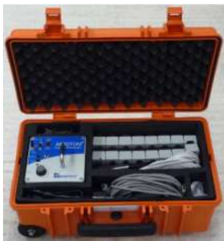
Рис. 1 Прибор импульсный томограф от компании RinnTechARBOTOM
