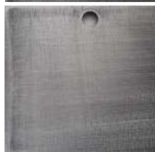
Рис. 1. Внешний вид образцов из стали Ст3 после ускоренных испытаний при различных концентрациях V3: а - контроль; б, с, д – 100, 200, 300 г/м 3 .
