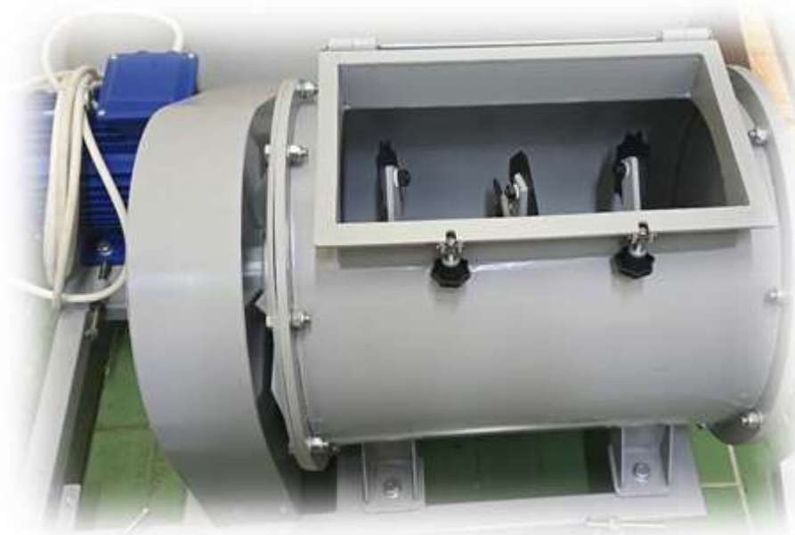
Рис. 1. Установка для ресурсных испытаний на коррозионно-механическое изнашивание рабочих органов сельскохозяйственных машин для животноводства и кормопроизводства
