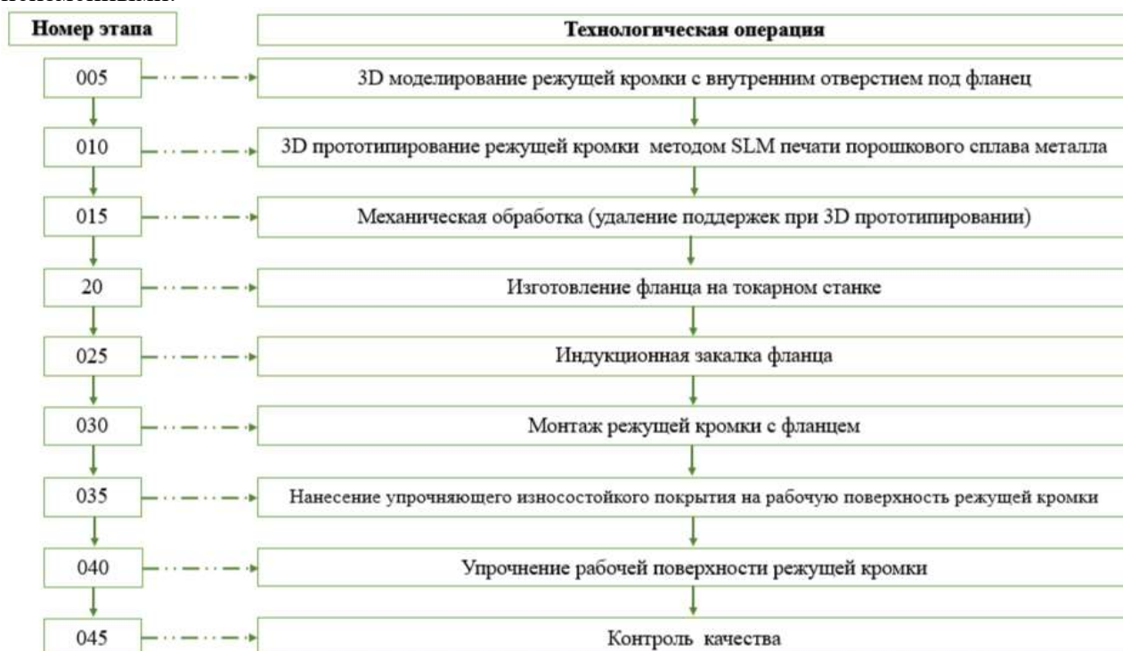
Рис. 2 Технология изготовления рабочих органов смесителей-кормораздатчиков при их модернизации
