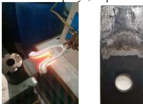
Рис. 1 Процесс наплавки ножа косилки КРН-2.1 на установке СВЧ-40АВ
