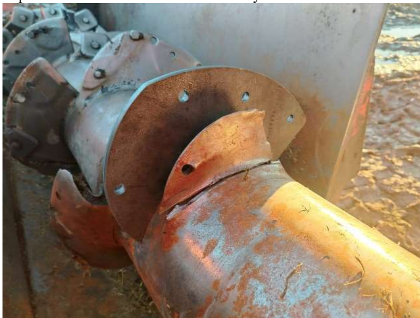
Рис. 2. Изношенный виток шнека в сравнении с новым
