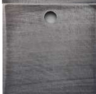
Рис. 1. Внешний вид образцов из стали Ст3 после ускоренных испытаний при различных концентрациях V3: а - контроль; б, с, д – 100, 200, 300 г/м 3 .
