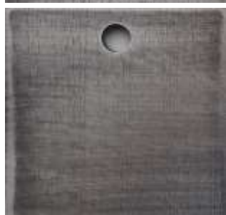
Рис. 1. Внешний вид образцов из стали Ст3 после ускоренных испытаний при различных концентрациях V3: а - контроль; б, с, д – 100, 200, 300 г/м 3 .
