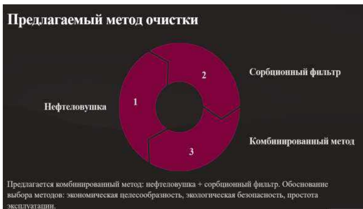
Рис. 1 Предлагаемый метод очистки сточных вод от нефтепродуктов
