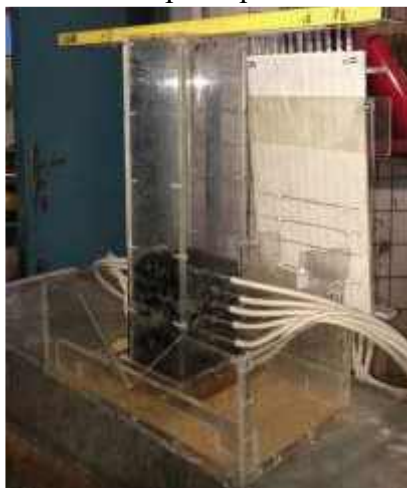
Рис. 2 Фото экспериментальной установки для определения фильтрационных характеристик с исследуемыми покрытиями:
