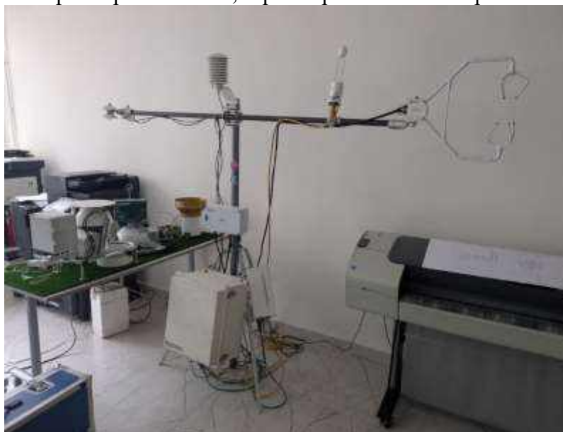
Рис.1 Вышка для измерения эмиссии ПГ методом турбулентных пульсаций
