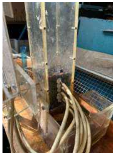
Рис. 2 Фото экспериментальной установки для определения фильтрационных характеристик с исследуемыми покрытиями:
