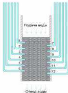
Рис. 1 Прибор для определения фильтрационных характеристик: а - прибор Дарси, б - схема расположения пьезометров в приборе Дарси:
