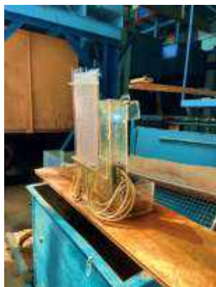
Рис. 1 Прибор для определения фильтрационных характеристик: а - прибор Дарси, б - схема расположения пьезометров в приборе Дарси:
