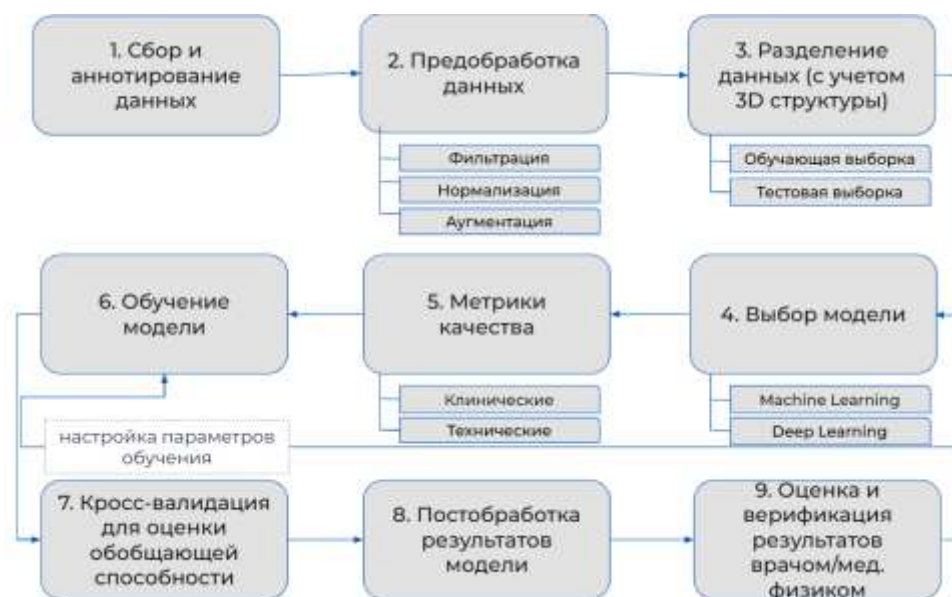
Рис. 1. Блок-схема общего конвейера анализа медицинских данных с помощью ИИ
