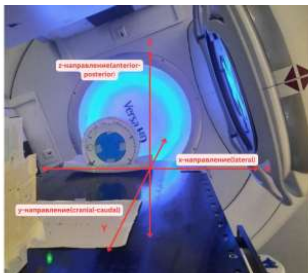
Рис. 4.3: Рис. 2. Фантом, находящийся в процедурном кабинете, и координаты движения стола
