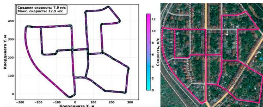
Рис. 2 – Маршрут движения автономно управляемого автомобиля в координатах (слева) и на карте (справа)
