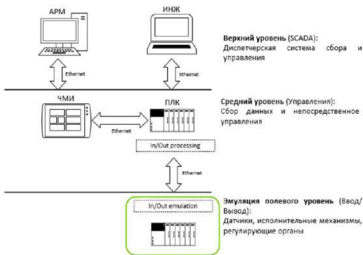
Рис. 1 — типовая схема АСУТП с заменой полевого уровня виртуальной эмуляцией
