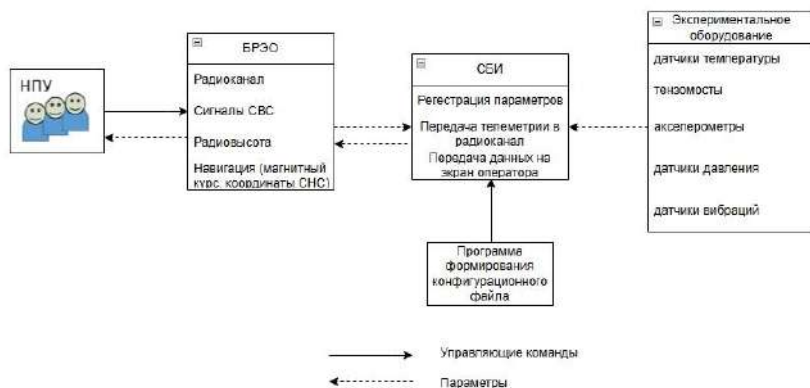
Рис. 1 – измерительный комплекс для проведения летных испытаний
