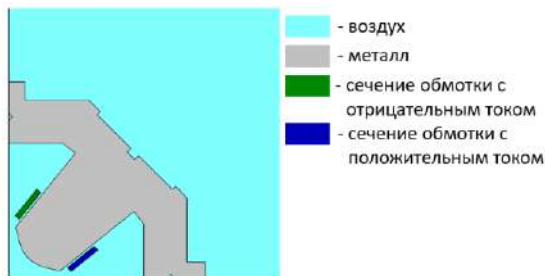
Рис. 1 – Вид четверти квадрупольного магнита в разрезе
