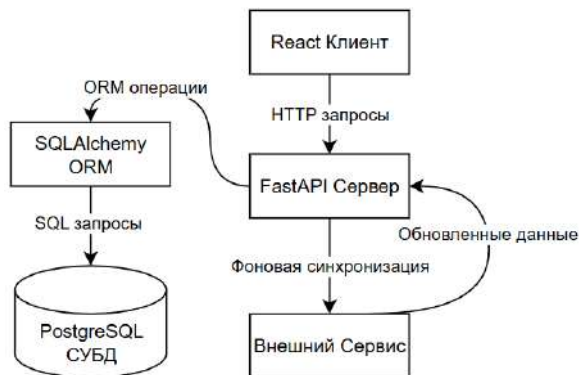
Рис.1 – Архитектура приложения «САПР образовательных программ» в веб-исполнении
