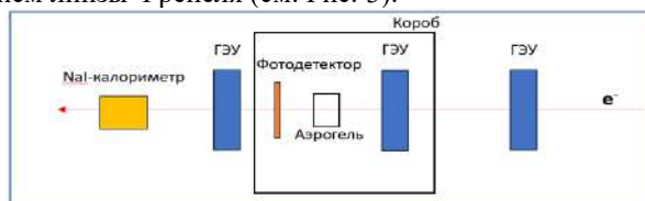
Рис.2 – В качестве трековой системы использовались ГЭУ – газовые электронные умножители с разрешением \sigma_y, \sigma_x \sim 50 \mu\text{m} . NaI-калориметр применялся для измерения энергии электронов. В качестве фотодетектора использовались 4 ФЭУ Hamamatsu H12700, каждый состоящий из 8 \times 8 пикселей размером 6 \times 6 \text{ мм}^2 .
