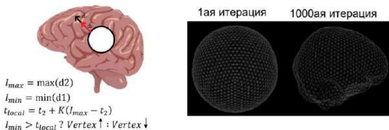
Рис.1 – Схема итеративного процесса деформации модели
