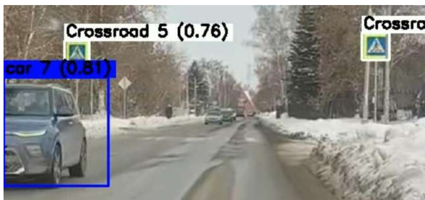
Рис. 2 – Визуализация обнаружения и отслеживания объектов на видео
