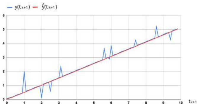
Рис. 1. Графическое представление \mathbf{Y} и \hat{\mathbf{Y}} при одиночных аномальных выбросах
