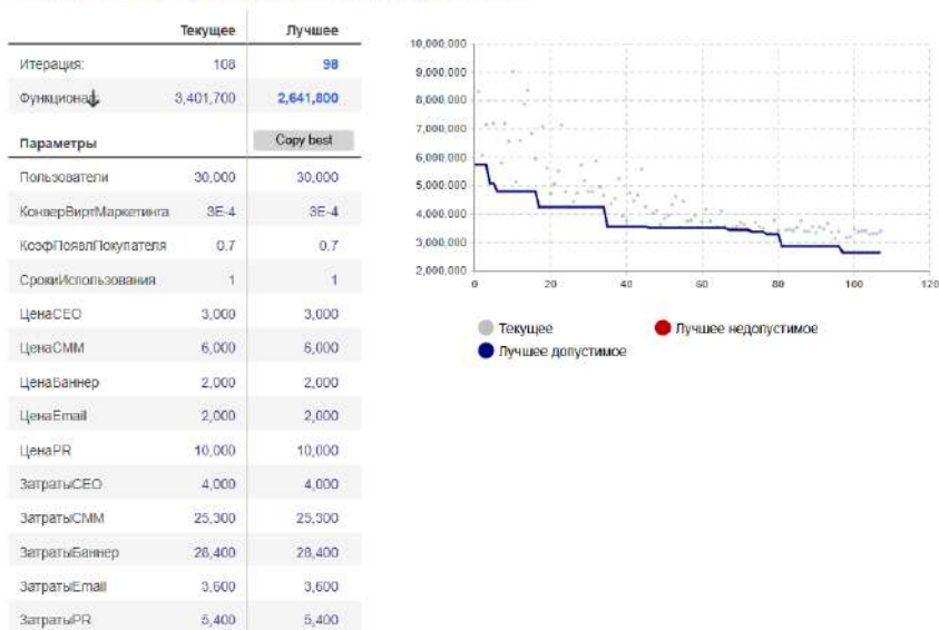
Рис. 2 - Работа оптимизационного эксперимента
