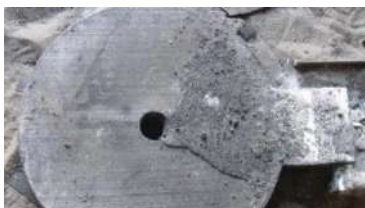
Рис. 2 – Пригар на поверхности отливки
