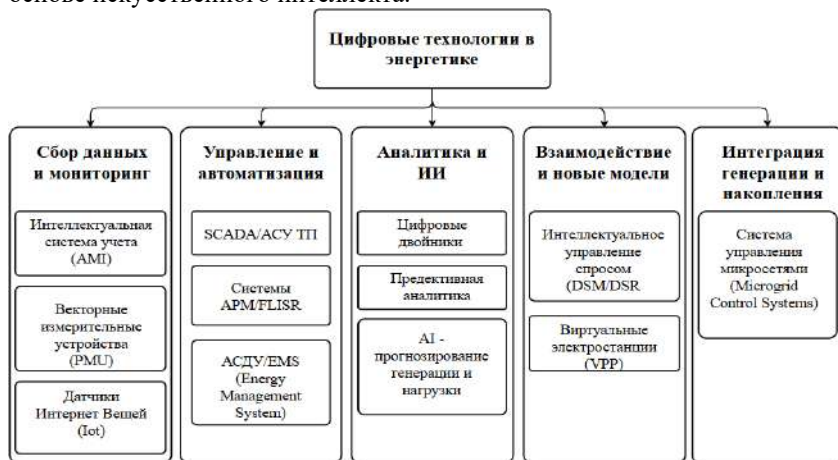
Рис. 1 – Виды цифровых технологий, применяемых в энергетике
