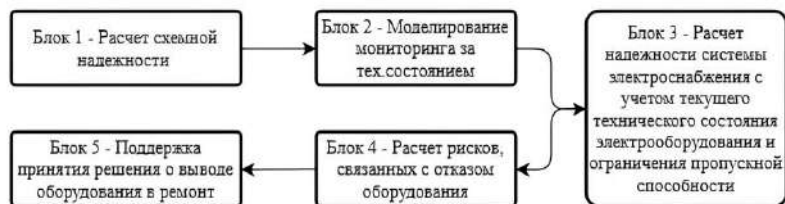
Рис. 1 – Схема функциональных блоков программного комплекса
