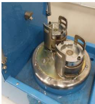
Рис. 3 – Лабораторная шаровая мельница планетарного типа с загруженными стаканами
