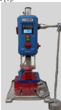
Рис. 1 – Общий вид универсального триботехнического комплекса «Универсал 1Б»
