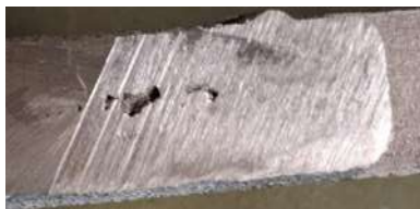
Рис. 6 – Усадочная раковина в отливке
