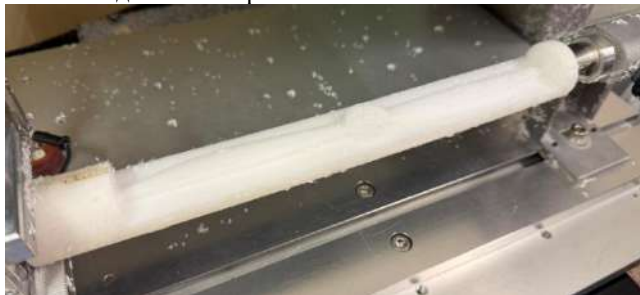
Рис. 1 – Заготовка после первого этапа обработки
