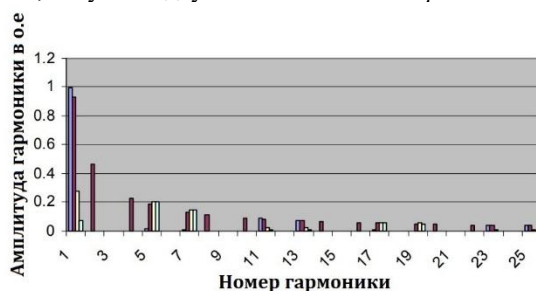
Рис.1 Гармонический состав МДС для разной величины q
