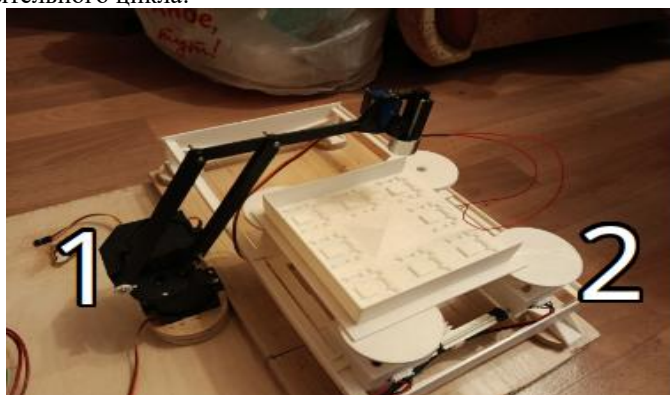
Рис.2 – Функциональный макет. 1 – Манипулятор на сервоприводах; 2 – Стол на подвижной платформе.
