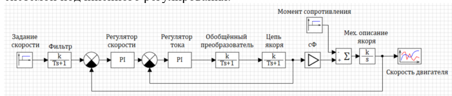
Рис.1 – структурная схема двухконтурной системы подчиненного регулирования скорости двигателя постоянного тока
